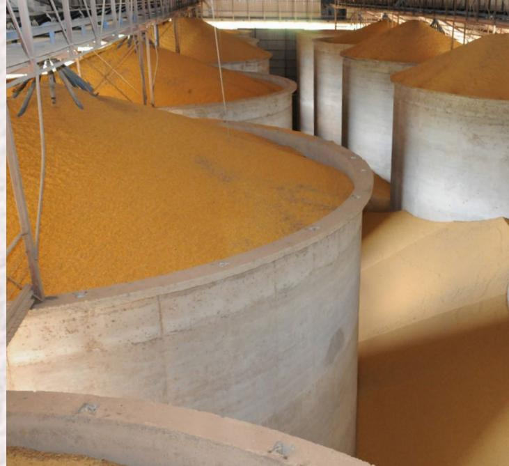
Após o recebimento, o grão passa pelo processo de pré-limpeza e secagem, caso esteja úmido.
